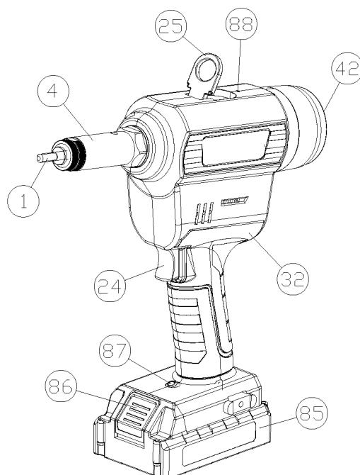
1- тяговый стержень, 4- кожух головки, 24- выключатель питания, 25- крючок, 32- шасси, 42- панель, 85- корпус для литиевой батареи, 86- замок корпуса для батареи, 87- светодиодный индикатор, 88- индикатор.
