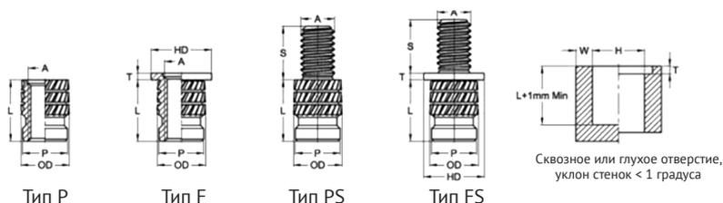
Метрические вставки PressFix, вид В, типы Р и F, без фланца и с фланцем, внутренняя резьба, размеры в мм
