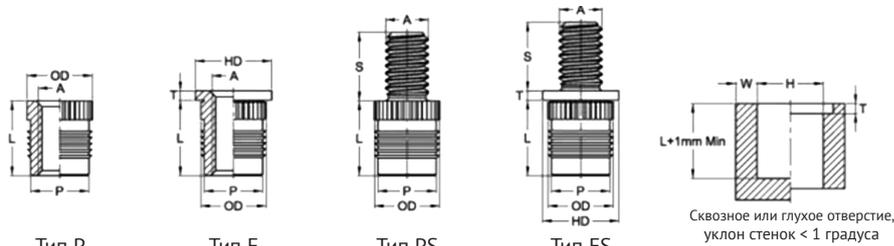
Метрические вставки Fixsert, вид R, типы P и F, без фланца и с фланцем, размеры в мм
