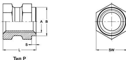
Метрические вставки MoldFix, вид S, тип Р, внутренняя резьба, размеры в мм
