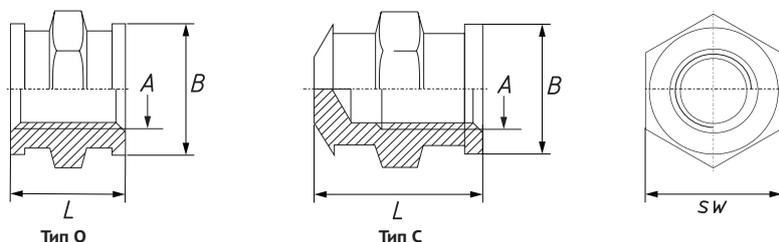
Метрические вставки MoldFix, вид К, типы О и С, открытая и закрытая, внутренняя резьба, размеры в мм
