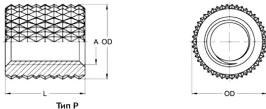
Метрические вставки MoldFix, вид А, тип Р, без фланца, внутренняя резьба, размеры в мм
