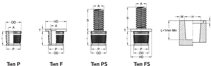
Метрические вставки HotFix, вид Т, типы Р и F, без фланца и с фланцем, внутренняя резьба, размеры в мм
