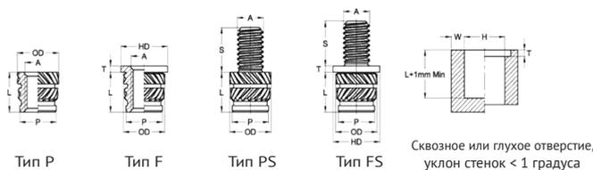
Метрические вставки HotFix, вид К, типы Р и F, без фланца и с фланцем, внутренняя резьба, размеры в мм
