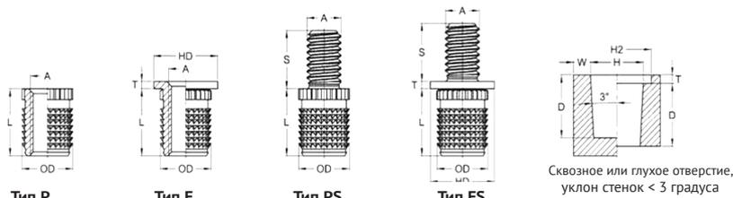
Метрические вставки HotFix, вид F, типы P и F, без фланца и с фланцем, внутренняя резьба, размеры в мм
