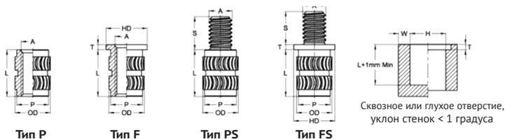
Метрические вставки HotFix, вид D, типы P и F, без фланца и с фланцем, внутренняя резьба, размеры в мм
