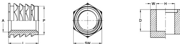
Метрические вставки FixSert, вид В, тип Р, без фланца со стандартным приводом, размер
