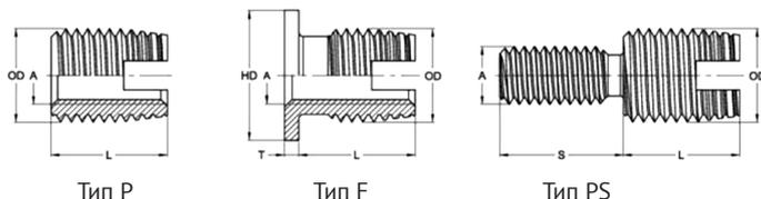
Метрические вставки FixSert, вид C, типы P и F, без фланца и с фланцем, внутренняя резьба, размеры в мм
