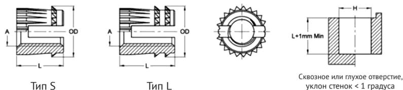
Метрические вставки ЕхраFix, вид C, типы S и L, внутренняя резьба, размеры в мм
