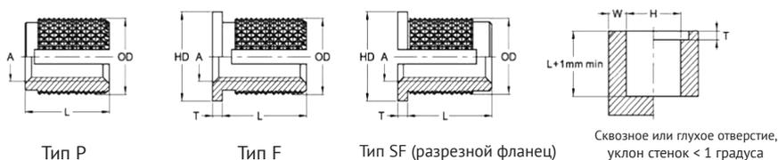
Метрические вставки ExtraFix, вид A, тип P, без фланца, размеры в мм
